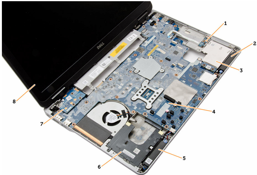
Slika 2. Pogled odozgo — Uklonjeni su tipkovnica i sklop oslonca za dlan
